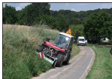
Fauchage mécanique d'accotements avec tracteur outils équipé d'un broyeur frontal
